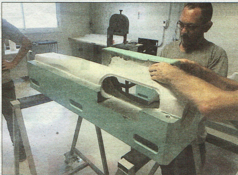
La cellule du drone, légère et résistante, est fabriquée à Cambaie en fibre de verre et kevlar. (Photos DR)
